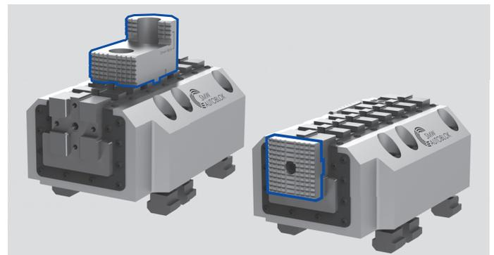
Der Klauenkasten kann mit Standard harten oder weichen Aufsatzbacken auf der Oberseite ausgerüstet werden. Ebenfalls lassen sich spezielle Spanneinsätze auf die Stirnseite aufsetzen. Diese Montageart eliminiert jegliche Hebelwirkung auf die Grundbacke, da der Spannungspunkt exakt in der Radialachse der Grundbacke liegt, und bietet somit eine sehr stabile und genaue Spannung. Auch wird dadurch die Aufbauhöhe verringert, was mit konventionellen Aufsatzbacken nicht möglich ist.
